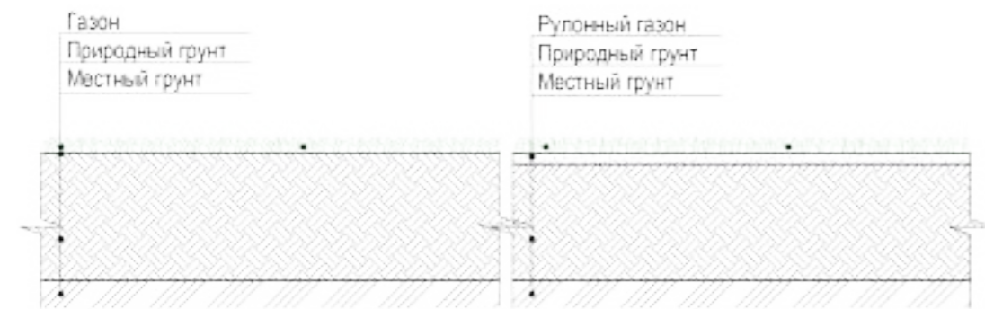
3.10 Схема устройства газона
